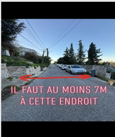
Prévoir des madriers pour faire un platelage dans le caniveau \_\_ Prévoir lors de l'ouverture du mur pour la rampe d'accès prévoir au moins 7 m de large pour stabilisateur arrière
