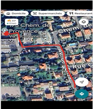
formule cadence avec client \_\_BQA 45m de tuyaux prévoir 2 sacs de ciment pour amorçage \_\_Vu avec client aire de lavage tuyaux et protection des sols obligatoire \_\_Vu avec client de prévoir des madrier pour faire des plattelage pour faciliter le coulage au tuyaux attention les toupies ne pourrons pas rentrer au portail (2,60)
